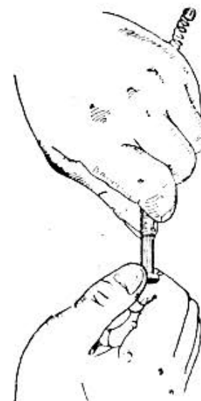
Rys. 45. Wyjmowanie żerdzi sprężyny powrotnej
