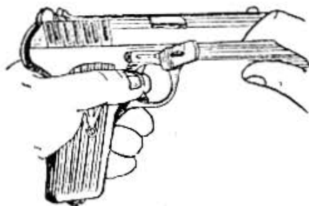
Rys. 33. Zsuwanie sprężyny zatrzasku zamkowego
