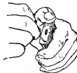
Rys. 42. Wciśnięcie zęba przytrzymywacza dna
