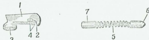
Рис. 28. Выбрасыватель с пружиной, стопором и фиксатором:
